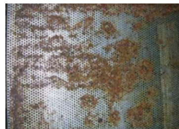
Grille zinc épaisseur 1 mm, entourée liste bois 1 cm trous de 4 mm de diamètre Source : L'Apis. n°9 décembre 2011
